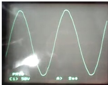
Figura 3 - Forma de onda da tensão da rede da concessionária.
