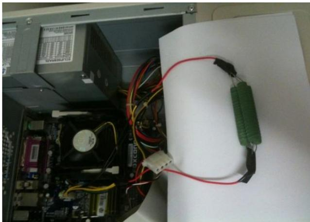
Para efeito comparativo, inicialmente foi medido o consumo do sistema ocioso que apresentava uma queda de 0,5V entre as extremidades do resistor, que significa uma passagem de corrente de 1,5A e uma potência de 17,25W para o sistema ocioso. Com o osciloscópio conectado também foi observado um aumento significativo do consumo de energia com a movimentação do mouse, que resultou em uma queda de 1V entre as extremidades do resistor, que resulta em uma corrente de 3A e uma potência de 33W.
