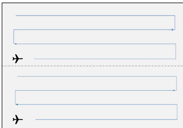
Figura 3. Buscas iniciais utilizando o padrão de Rotas Paralelas para dois VANTS, explorando por varredura todo o espaço de busca, que foi dividido em duas subáreas.
