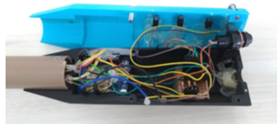
Figure 5: Cabo com circuito da bengala montado
