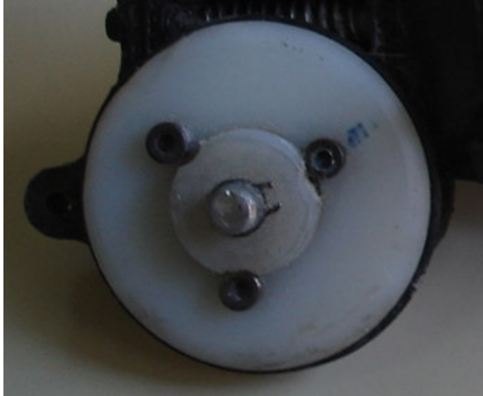
Figura 01: Roda de 6 cm de diâmetro usinada em nylon e fixada diretamente no eixo do motor
