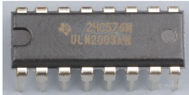
Figura 12– composição interna e externa do ULN2003A Fonte: ULN2003A [13]
