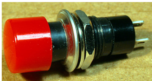
Figura 02 – Push button, utilizado como sensor de toque no robô de sumô Suricate.
