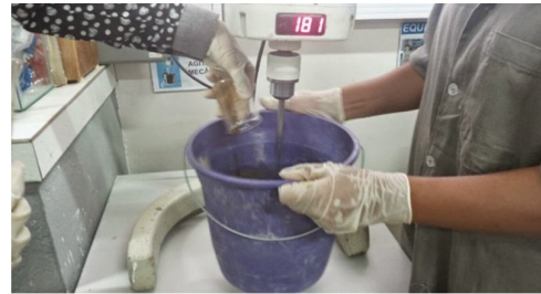
Figura 11- Aditivo sendo adicionado à argamassa
