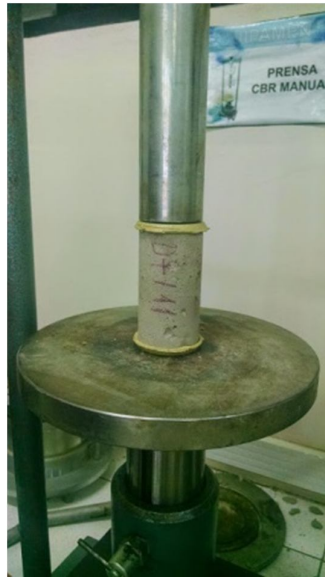
Figura 13 - Corpo de prova sendo preparado para sofrer a compressão
