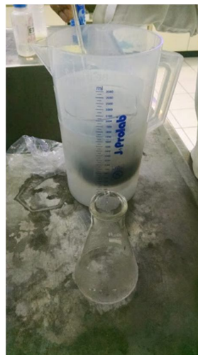
Figura 2 - Recipiente imerso no gelo e recebendo água destilada gelada
