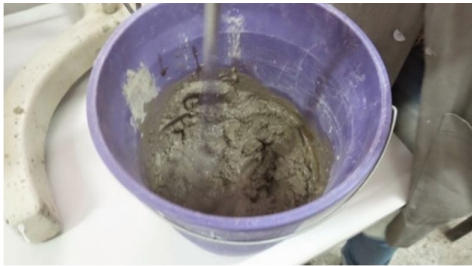
Figura 11 - Argamassa, já com a adição de água, no misturador
