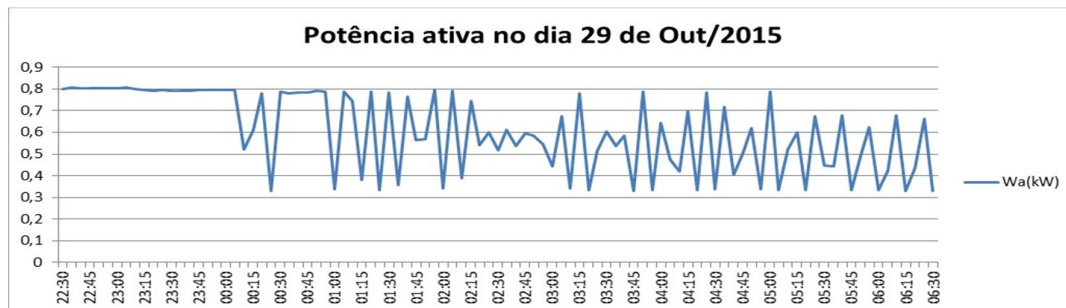
Figura 17 – Medição da potência do ar condicionado na temperatura de 21° C
