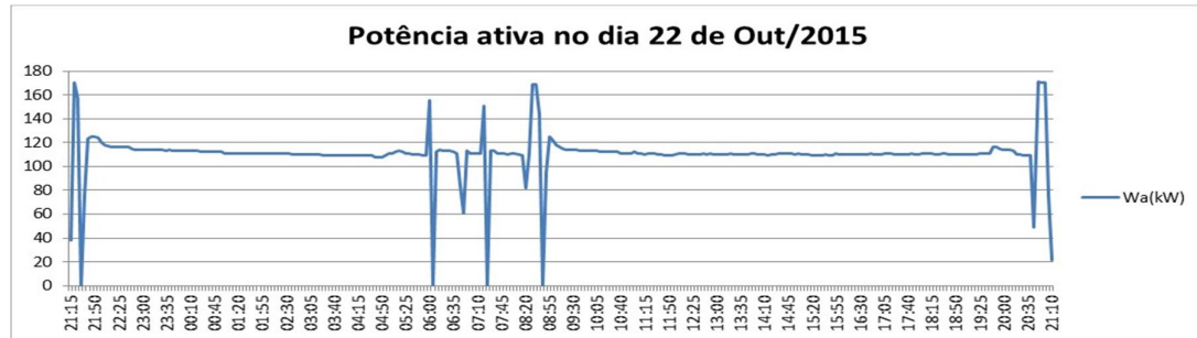
Figura 14 – Medição da potência da geladeira no carregamento máximo.
