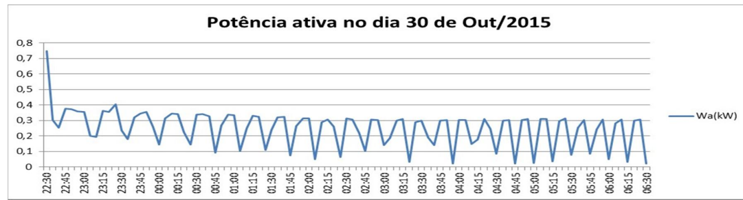
Figura 16 – Medição da potência do ar condicionado na temperatura de 25° C
