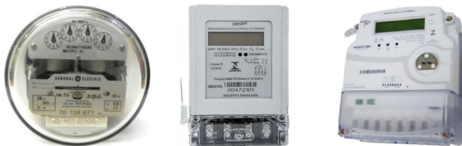
Figura 3 - Medidor analógico (esq.), inteligente com AMR (centro) e inteligente com AMM (dir.)
