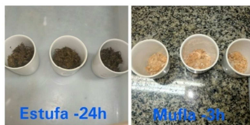
Figura 3 – Amostras após 24h na estufa e 3h na mufla
