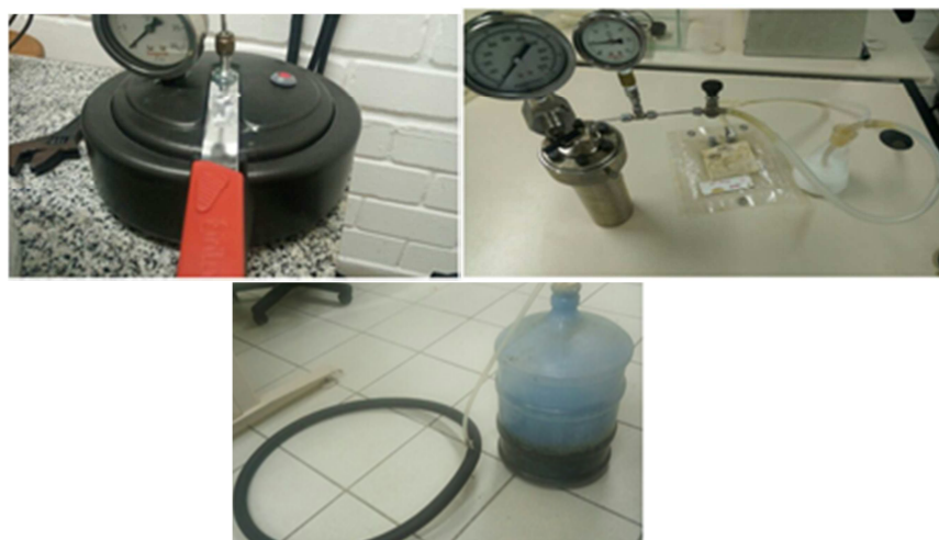
Figura 4 – Os três biodigestores devidamente montados
