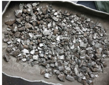
Figura 10 – Amostra da Liga de FeSiMn recuperada após a jigagem.
