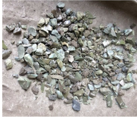
Figura 9 – Amostra da escória de FeSiMn após da jigagem.
