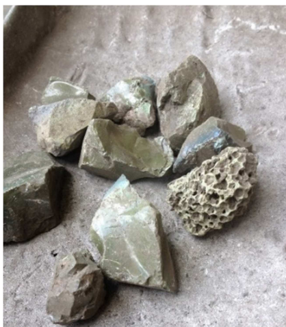
Figura 5 – Escória de FeSiMn depois do processo de jigagem.
