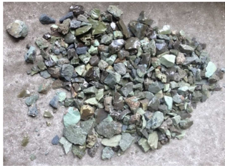
Figura 9 – Amostra da escória de FeSiMn após da jigagem.
