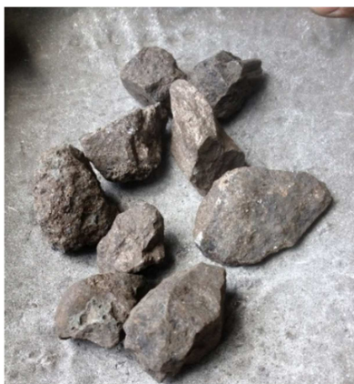
Figura 6 – Liga de FeSiMn recuperada após a jigagem.
