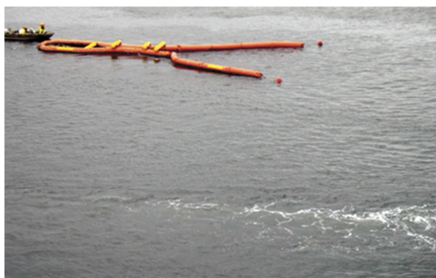
Figura 3 - Barreiras apropriadas para recolhimento de óleos em lâminas tênues de aspecto iridescente a prateado
